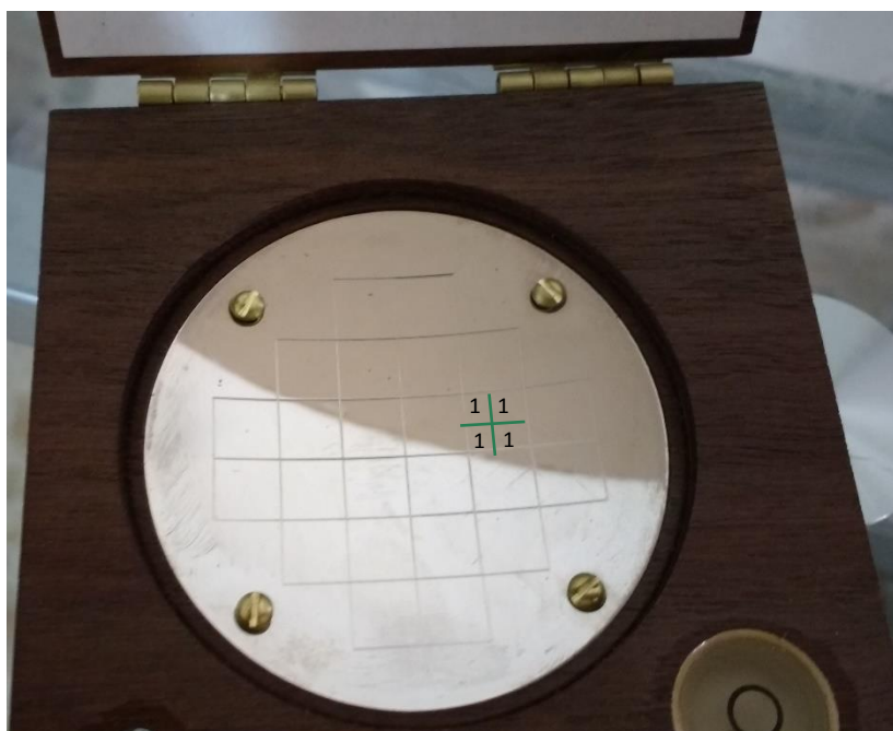
Figura 24. Densiómetro cóncavo. Fotografía: Magda Vanegas López.
