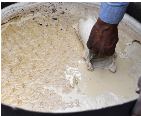
Proceso de "charqueado" de la cera de candelilla. La cera líquida se separa de las impurezas y del agua por sedimentación.
